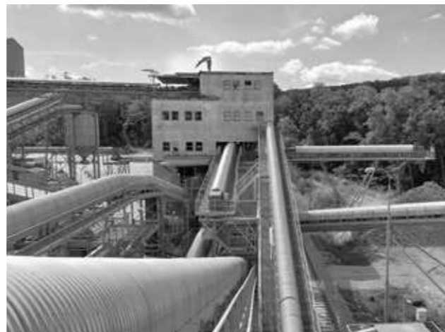
Doplnění linky o haldovací dopravník frakce 100-300 mm v lince kamenolomu OLBRAMOVICE
