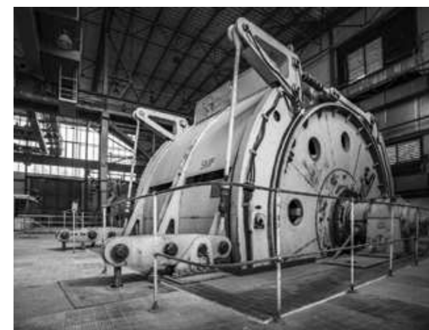
Historické těžní stroje V 6118 z provenience ČKD Praha z r. 1975 určené pro těžbu z hloubky až 1 500 m
