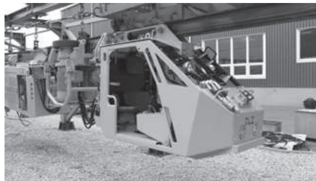
Důlní bateriová lokomotiva Ferrit DLZA30F
