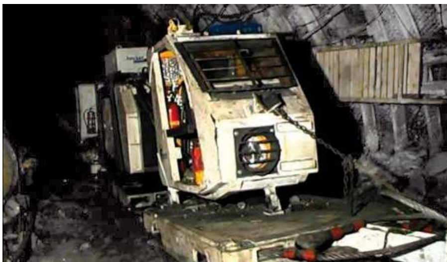
Obr. č. 1: Doprava pomocí ozubnicové dráhy a dieslového tahače [3].
