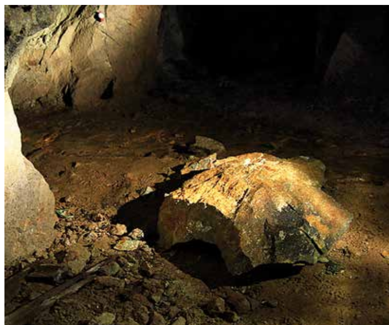
Obr. č. 2: Uvolněný kus horniny ze stropu
