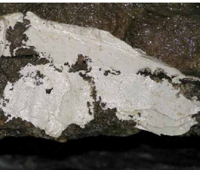
Obr. č. 1: Příklad sádrového terčíku (T9) na sledované subhorizontální puklině
