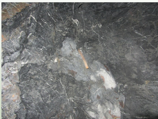
Obr 2: Vrták, který se již nepodařilo vytáhnout. Foto J. Jiskra
